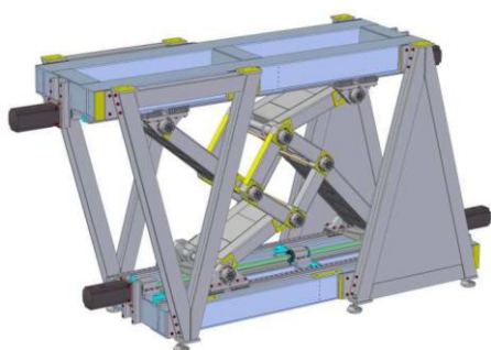
Obr. 5 a) stroj Sliding Star s nadbytočným počtom hnacích členov b) zobrazenie usporiadania hnacích členov a upínacej dosky
