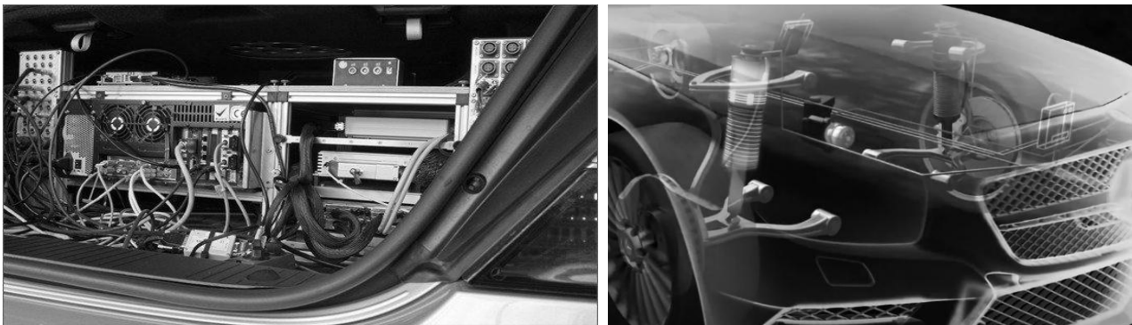
Obr.6 a) sústava riadenia Magic Body Control, b) výkonová sústava Active Body Control
